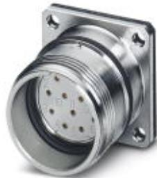
Connettore per apparecchi anteriore, RC, diritto, schermati: sì, Bloccaggio a vite, M23, N. poli: 12, tipo contatti: femmina, Attacco a saldare, Guarnizione piatta, 4x Ø 3,2
