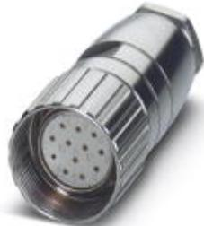
Connettore per cavo, RC, diritto, schermati: no, Bloccaggio a vite, M23, N. poli: 12, tipo contatti: femmina, Attacco a saldare
