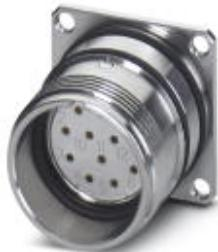
Connettore per apparecchi posteriore, RC, diritto, Bloccaggio a vite, M23, N. poli: 12, tipo contatti: femmina, Connessione a saldare, O-ring radiale, 4xM3, Spessore della parete min.: 2,7 mm, Spessore della parete max.: 3,5 mm
