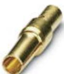
Contatto a crimpare, tornito, Contatto singolo, diametro contatti: 1 mm, intervallo di crimpatura: 0,08 mm<sup>2</sup> ... 0,22 mm<sup>2</sup>
