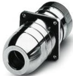
Passaparete posteriore, RC, diritto, schermati: sì, Bloccaggio a vite, M23, N. poli: 12, tipo contatti: femmina, Attacco a crimpere, Guarnizione piatta, 4xM3, Spessore della parete max.: 2,5 mm
