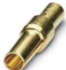
Contatto a crimpire, tornito, Contatto singolo, diametro contatti: 1 mm, intervallo di crimpatura: 0,08 mm<sup>2</sup> ... 0,22 mm<sup>2</sup>
