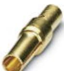
Contatto a crimpare, tornito, Contatto singolo, diametro contatti: 1 mm, intervallo di crimpatura: 0,14 mm<sup>2</sup> ... 0,56 mm<sup>2</sup>
