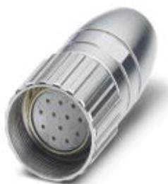
Connettore per cavo, RC, diritto, schermati: sì, Bloccaggio a vite, M23, N. poli: 12, tipo contatti: femmina, Attacco a crimpare, diametro cavi: 3 mm ... 10,5 mm
