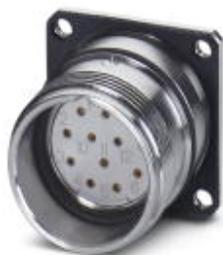
Connettore per apparecchi posteriore, RC, diritto, Bloccaggio a vite, M23, N. poli: 12, tipo contatti: femmina, Attacco a crimpare, Guarnizione piatta, 4xM3, Spessore della parete min.: 2,7 mm, Spessore della parete max.: 3,5 mm
