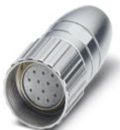
Connettore per cavo, RC, diritto, schermati: sì, Bloccaggio a vite, M23, N. poli: 12, tipo contatti: femmina, Attacco a saldare, diametro cavi: 3 mm ... 10,5 mm
