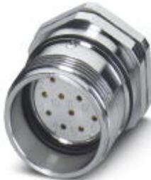
Connettori per apparecchi con filettatura a vite M20 x 1,5, RC, diritto, schermati: sì, Bloccaggio a vite, M23, N. poli: 12, tipo contatti: femmina, Attacco a saldare, O-ring assiale, Fissaggio centrale, Spessore della parete min.: 0,8 mm, Spessore della parete max.: 6,5 mm
