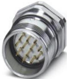
Connettori per apparecchi con filettatura a vite M20 x 1,5, RC, diritto, schermati: sì, Bloccaggio a vite, M23, N. poli: 12, tipo contatti: Maschio, Attacco a saldare, Guarnizione assiale, Fissaggio centrale, Spessore della parete min.: 0,8 mm, Spessore della parete max.: 6,5 mm
