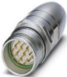
Connettore per giunti, RC, diritto, schermati: sì, Bloccaggio a vite, M23, N. poli: 12, tipo contatti: Maschio, Attacco a crimpare, diametro cavi: 6,5 mm ... 7,5 mm
