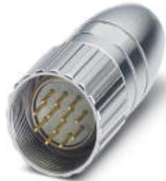
Connettore per cavo, RC, diritto, schermati: sì, Bloccaggio a vite, M23, N. poli: 12, tipo contatti: Maschio, Attacco a crimpere, diametro cavi: 3 mm ... 10,5 mm
