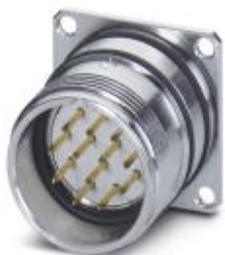
Connettore per apparecchi posteriore, RC, diritto, Bloccaggio a vite, M23, N. poli: 12, tipo contatti: Maschio, Attacco a crimpare, O-ring radiale, 4xM3, Spessore della parete min.: 2,7 mm, Spessore della parete max.: 3,5 mm
