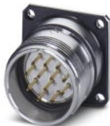
Connettore per apparecchi posteriore, RC, diritto, Bloccaggio a vite, M23, N. poli: 12, tipo contatti: Maschio, Attacco a crimpare, Guarnizione piatta, 4xM3, Spessore della parete min.: 2,7 mm, Spessore della parete max.: 3,5 mm
