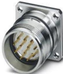
Connettore per apparecchi anteriore, RC, diritto, schermati: sì, Bloccaggio a vite, M23, N. poli: 12, tipo contatti: Maschio, Attacco a crimpere, Guarnizione piatta, 4x Ø 3,2
