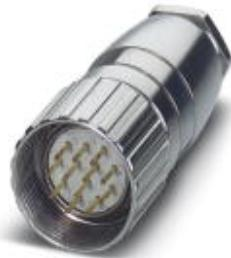
Connettore per cavo, RC, diritto, schermati: no, Bloccaggio a vite, M23, N. poli: 12, tipo contatti: Maschio, Attacco a crimpere, diametro cavi: 6 mm ... 10 mm
