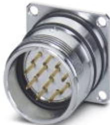
Connettore per apparecchi posteriore, RC, diritto, schermati: sì, Bloccaggio a vite, M23, N. poli: 12, tipo contatti: Maschio, Connessione a saldare, O-ring radiale, 4xM2,5, Spessore della parete min.: 2,7 mm, Spessore della parete max.: 3,5 mm
