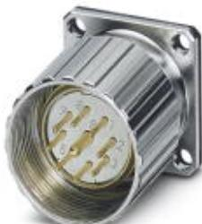
Connettore per apparecchi anteriore con dado zigrinato, RC, diritto, schermati: no, Bloccaggio a vite, M23, N. poli: 12, tipo contatti: Maschio, Attacco a saldare, Guarnizione piatta, 4x Ø2,7
