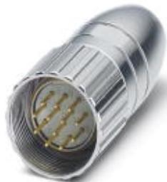
Connettore per cavo, RC, diritto, schermati: sì, Bloccaggio a vite, M23, N. poli: 12, tipo contatti: Maschio, Attacco a saldare
