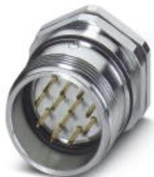
Connettori per apparecchi con filettatura a vite M20 x 1,5, RC, diritto, schermati: sì, Bloccaggio a vite, M23, N. poli: 12, tipo contatti: Maschio, Attacco a saldare, Guarnizione assiale, Fissaggio centrale
