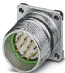
Connettore per apparecchi anteriore, RC, diritto, schermati: sì, Bloccaggio a vite, M23, N. poli: 12, tipo contatti: Maschio, Attacco a saldare, Guarnizione piatta, 4x Ø2,7, misura flangia: 25 mm x 25 mm
