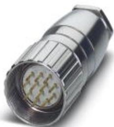
Connettore per cavo, RC, diritto, schermati: no, Bloccaggio a vite, M23, N. poli: 12, tipo contatti: Maschio, Attacco a saldare, diametro cavi: 4 mm ... 6 mm
