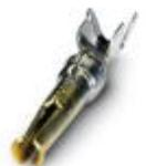
Contatto a crimpare, in rotolo, Contatto singolo, diametro contatti: 1 mm, intervallo di crimpatura: 0,22 mm<sup>2</sup> ... 0,56 mm<sup>2</sup>
