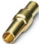
Contatto a crimpare, tornito, diametro contatti: 2 mm, intervallo di crimpatura: 0,5 mm<sup>2</sup> ... 0,75 mm<sup>2</sup>
