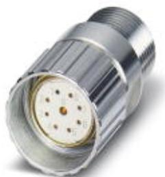
Connettore per apparecchi anteriore, RC, diritto, schermati: sì, Bloccaggio a vite, M23, N. poli: 8+1, tipo contatti: femmina, Attacco a saldare, O-ring assiale, Fissaggio centrale Pg13,5
