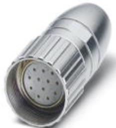
Connettore per cavo, RC, diritto, schermati: sì, Bloccaggio a vite, M23, N. poli: 8+1, tipo contatti: femmina, Attacco a saldare, diametro cavi: 3 mm ... 10,5 mm
