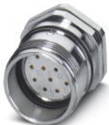
Connettori per apparecchi con filettatura a vite M20 x 1,5, RC, diritto, schermati: sì, Bloccaggio a vite, M23, N. poli: 8+1, tipo contatti: femmina, Attacco a saldare, O-ring assiale, Fissaggio centrale, Spessore della parete min.: 0,8 mm, Spessore della parete max.: 6,5 mm
