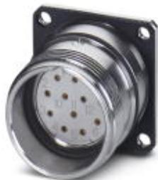
Connettore per apparecchi posteriore, RC, diritto, Bloccaggio a vite, M23, N. poli: 8+1, tipo contatti: femmina, Attacco a saldare, Guarnizione piatta, 4xM3, Spessore della parete min.: 2,7 mm, Spessore della parete max.: 3,5 mm
