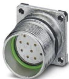
Connettore per apparecchi anteriore, RC, diritto, schermati: sì, Bloccaggio a vite, M23, N. poli: 8+1, tipo contatti: femmina, Attacco a saldare, Guarnizione piatta, 4x Ø2,7, misura flangia: 25 mm x 25 mm
