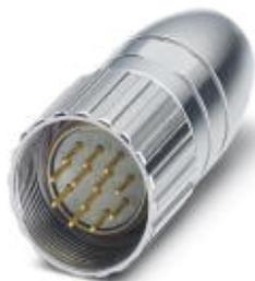
Connettore per cavo, RC, diritto, schermati: sì, Bloccaggio a vite, M23, N. poli: 8+1, tipo contatti: Maschio, Attacco a crimpare, diametro cavi: 5,5 mm ... 6,5 mm
