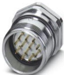
Connettori per apparecchi con filettatura a vite M20 x 1,5, RC, diritto, schermati: sì, Bloccaggio a vite, M23, N. poli: 8+1, tipo contatti: Maschio, Attacco a crimpare, Guarnizione assiale, Fissaggio centrale, Spessore della parete min.: 0,8 mm, Spessore della parete max.: 6,5 mm
