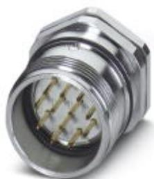
Connettori per apparecchi con filettatura a vite M20 x 1,5, RC, diritto, schermati: sì, Bloccaggio a vite, M23, N. poli: 8+1, tipo contatti: Maschio, Attacco a saldare, O-ring assiale, Fissaggio centrale, Spessore della parete min.: 0,8 mm, Spessore della parete max.: 6,5 mm
