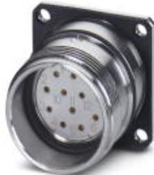
Connettore per apparecchi posteriore, RC, diritto, Bloccaggio a vite, M23, Guarnizione piatta, 4xM3, Spessore della parete min.: 2,7 mm, Spessore della parete max.: 3,5 mm
