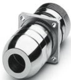
Passaparete anteriore, RC, diritto, schermati: sì, Bloccaggio a vite, M23, N. poli: 7, tipo contatti: femmina, Attacco a saldare, Guarnizione piatta, 4x Ø 3,2, Spessore della parete min.: 3 mm, Spessore della parete max.: 7 mm, diametro cavi: 3 mm ... 10,5 mm
