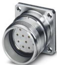
Connettore per apparecchi anteriore, RC, diritto, schermati: sì, Bloccaggio a vite, M23, N. poli: 7, tipo contatti: femmina, Attacco a saldare, Guarnizione piatta, 4x Ø 3,2
