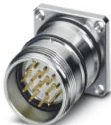
Connettore per apparecchi posteriore, RC, diritto, schermati: sì, Bloccaggio a vite, M23, N. poli: 7, tipo contatti: Maschio, Attacco a crimpare, Guarnizione piatta, 4xM3, Spessore della parete min.: 3 mm, Spessore della parete max.: 10,5 mm
