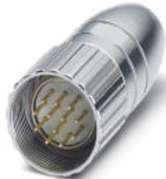
Connettore per cavo, RC, diritto, schermati: sì, Bloccaggio a vite, M23, N. poli: 7, tipo contatti: Maschio, Attacco a saldare, diametro cavi: 7,5 mm ... 9,5 mm
