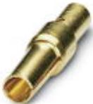
Contatto a crimpare, tornito, diametro contatti: 2 mm, intervallo di crimpatura: 1,5 mm<sup>2</sup> ... 2,5 mm<sup>2</sup>
