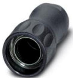
Connettore per cavo, RC, Plastica diritta, rivestita, schermati: sì, Bloccaggio a vite, M23, diametro cavi: 7,5 mm ... 9,5 mm
