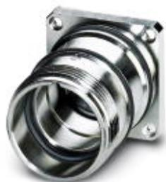
Custodia da incasso, serie: RC, diritto, Bloccaggio a vite, M23, O-ring radiale, 4xM3, schermata: sì, spessore della parete min.: 3 mm, spessore della parete max.: 10,5 mm
