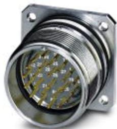
Connettore per apparecchi posteriore, diritto, Bloccaggio a vite, M27, numero poli: 28, tipo contatti: Maschio, Connessione a saldare, O-ring radiale, 4xM3, schermata: sì
