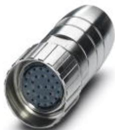
Connettore per cavi, diritto, Bloccaggio a vite, M27, numero poli: 26, tipo contatti: femmina, Attacco a saldare, schermata: sì
