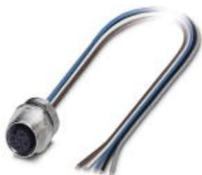
Connettore femmina da incasso sensore-attuatore, 5 poli, M12, codifica A, montaggio anteriore/a vite con filettatura Pg9, con filo TPE da 1 m, 5x 0,34 mm<sup>2</sup>
