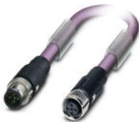
Cavo di sistema bus, CANopen<sup>®</sup>, DeviceNet<sup>™</sup>, 5-poli, PUR senza alogenati, viola RAL 4001, schermata, Maschio diritto M12 SPEEDCON, codifica: A, su Femmina diritto M12 SPEEDCON, codifica: A, lunghezza cavo: 25 m
