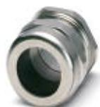
Attacchi a vite in metallo fino a 5 bar, lunghezza filettatura: 8 mm, diametro cavo : 27 ... 34 mm, SW 50, attacco a vite: M40
