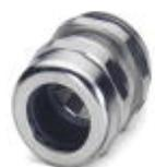
Connessione a vite per cavo, materiale viti: Ottone, nichelato, diametro esterno cavo 19 mm ... 27 mm, schermatura: sì, filettatura: M40 x 1,5, colore: argento, con O-ring
