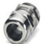
Connessione a vite per cavo, materiale viti: Ottone, nichelato, diametro esterno cavo 19 mm ... 28 mm, schermatura: no, filettatura: M40 x 1,5, colore: argento, con O-ring
