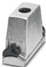
Custodia mobile HEAVYCON ADVANCE B24, con bloccaggio a baionetta (esagono cavo) in acciaio inox, alluminio impermeabile, altezza 100 mm, con filettatura 1x M40, uscita cavo diritta, senza superficie; guarnizione conduttiva (caratteristiche EMC)
