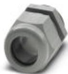
Connessione a vite per cavo, materiale viti: PA, diametro esterno cavo 19 mm ... 28 mm, schermatura: no, filettatura: M40 x 1,5, colore: grigio-argento RAL 7001
