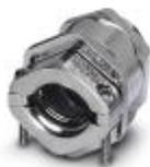
Connessione a vite in metallo con fascetta fermacavo, lungh. filettatura: 8 mm, campo di tenuta: 24 - 33 mm, campo di connessione: 26 - 36 mm, SW 50, conness. a vite: M40
