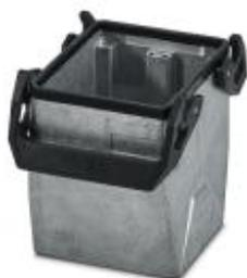
Custodia per giunti B32, con blocc. trasversale, materiale: Pressofuso di alluminio, impermeabile, uscite cavi: 1, diritto, altezza: 99,8 mm, connessione a vite per cavo: senza, perno: no, 1x Pg42, Standard
