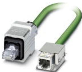
Cavo PROFINET confezionato, CAT5e, schermato, Sternvierer, AWG 22 compatibile con catene portacavi (7 fili), RAL 6018 (giallo-verde), modulo femmina RJ45/IP20 per sistema Freenet, 4 poli su connettore maschio RJ45/IP67, Push-Pull, custodia in metallo, Line, lunghezza 2 m
