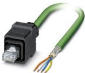
Cavo PROFINET confezionato, CAT5e, schermato, Sternvierer, AWG 22 compatibile con catene portacavi (7 fili), RAL 6018 (giallo-verde), connettore maschio RJ45/IP67, Push-Pull, custodia in plastica, su estremità libera, Line, lunghezza 5 m
