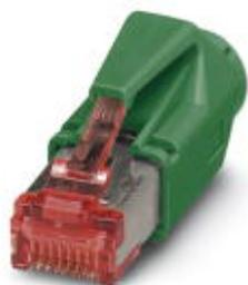
Connettore RJ45, grado di protezione: IP20, numero poli: 8, 1 Gbit/s, CAT6, materiale: PA, collegamento: Connessione IDC, sezione di connessione: AWG 24- 27, uscita cavo: diritto, colore: verde
